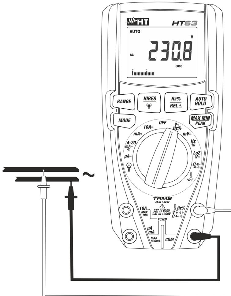
Abb. 3: Verwendung des Gerätes für Wechselspannungsmessung
