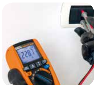
LoZ Funktion eliminiert Streuspannungen.
