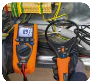
Messung des Stroms mit flexiblem Wandler.
