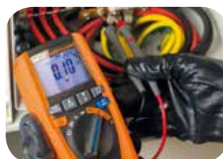
Durchgangsprüfung von Schutzleitern.
