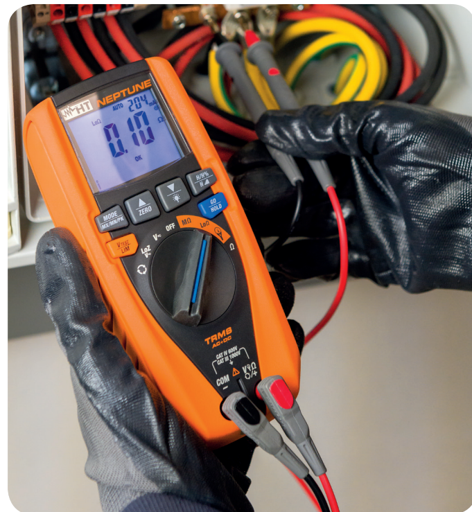
Durchgangsprüfung von Schutzleitern mit 200mA.
