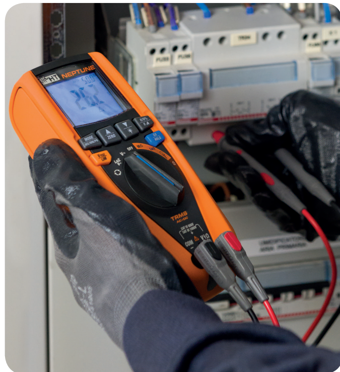
Spannungsmessung mit Messleitungen.
