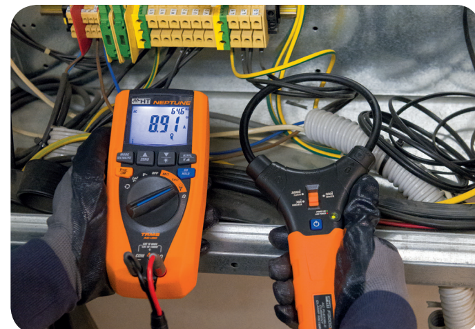
Messung des Stroms mit flexiblem Wandler F3000U.
