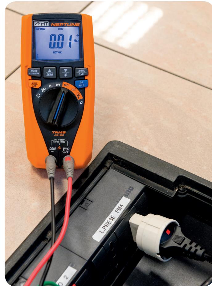
Isolationsmessung (mit optionalem Schuko C2065 Adapter).
