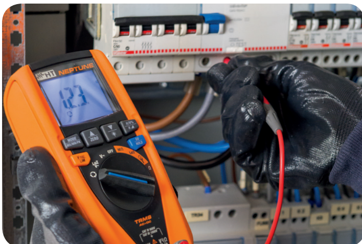
Drehfeldrichtung mit 1-phasiger Methode.
