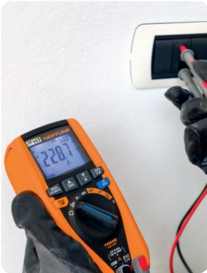
LoZ Funktion eliminiert Streuspannungen.
