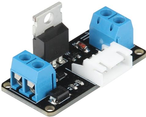
Mit dem COM-MOSFET können Sie eine Spannung von bis zu 36 Volt steuern. Mit Hilfe von Pulsweitenmodulation kann auch die Effektivspannung gesenkt werden (z. B. zum Dimmen einer LED Beleuchtung).
