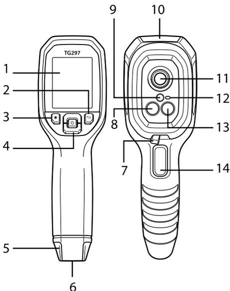
**Abbildung 4.1** Beschreibung des bildgebenden IR-Thermometers (TG297 abgebildet)
