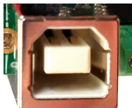
Abb. 2: USB-Interface 2.0 (Typ B)
