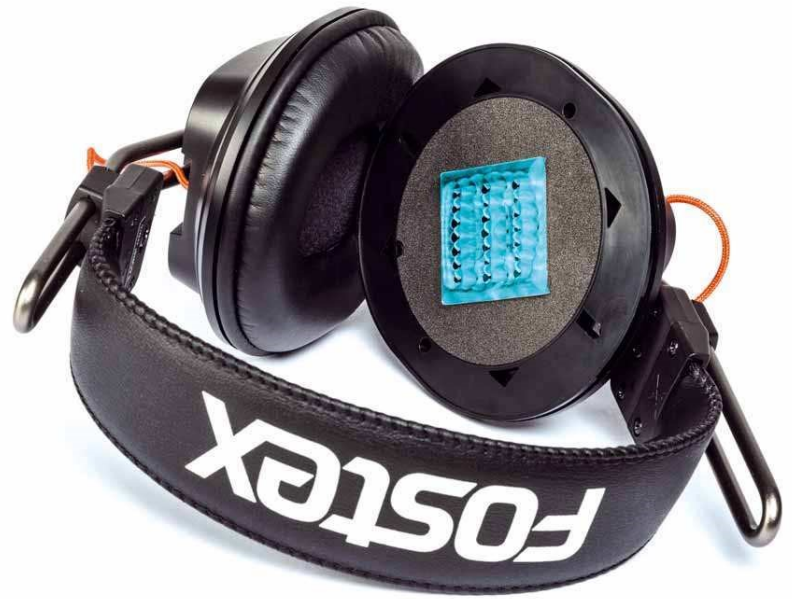
Mit der SLA-Technik lassen sich auch filigrane Objekte sehr präzise drucken. Hier haben wir spezielle Schallführungen für Kopfhörer gedruckt
