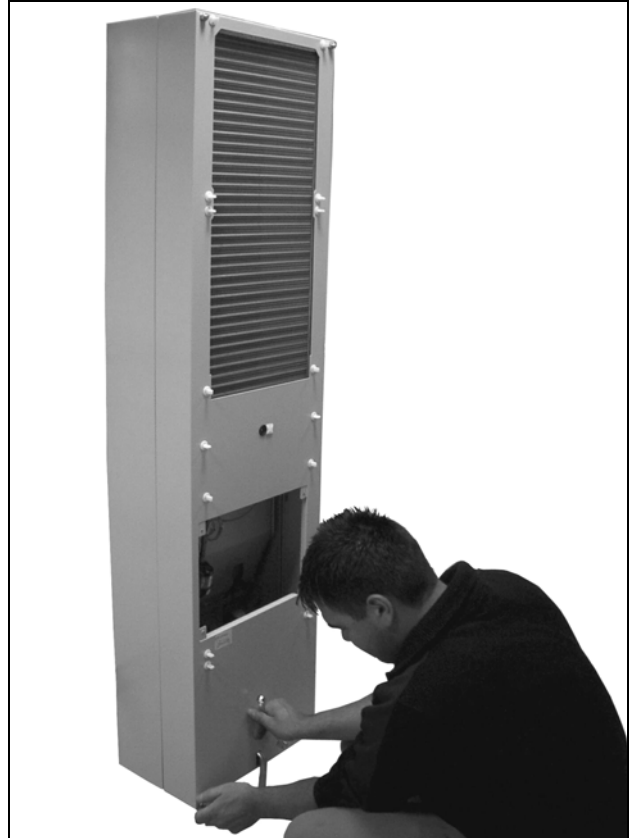
Abb. 70: Vier Muttern der Haube lösen
