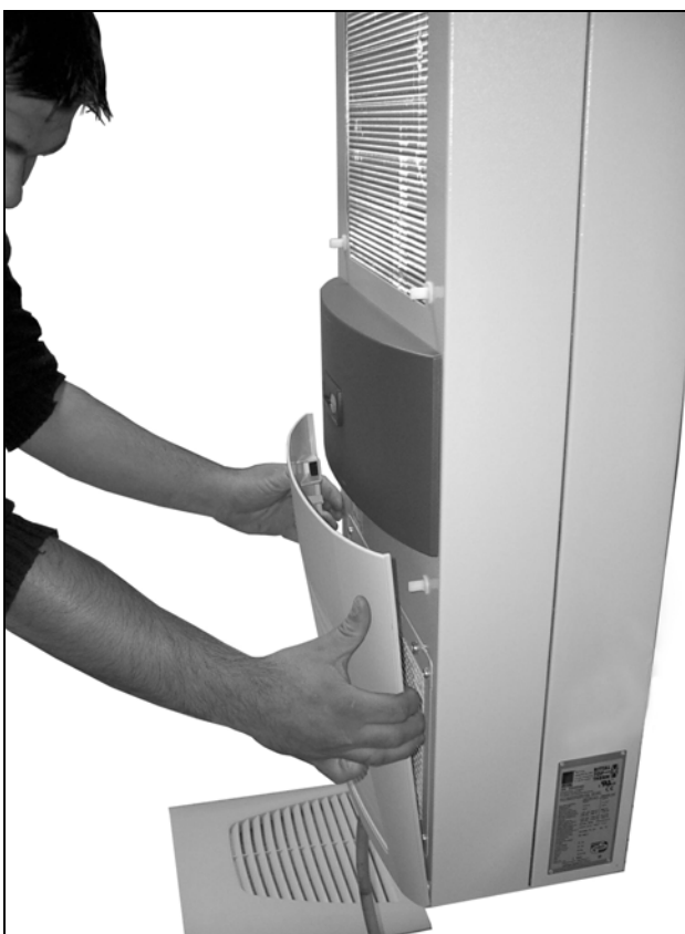
Abb. 36: Unteres Lamellengitter entfernen
