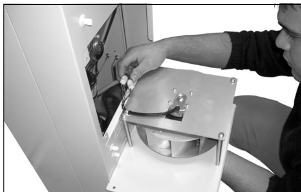
Abb. 65: Steckverbindungen des Lüfters abziehen (1)
