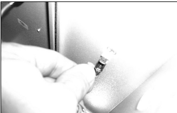
Abb. 69: Erdungskabel des Lüfters abziehen (2)
