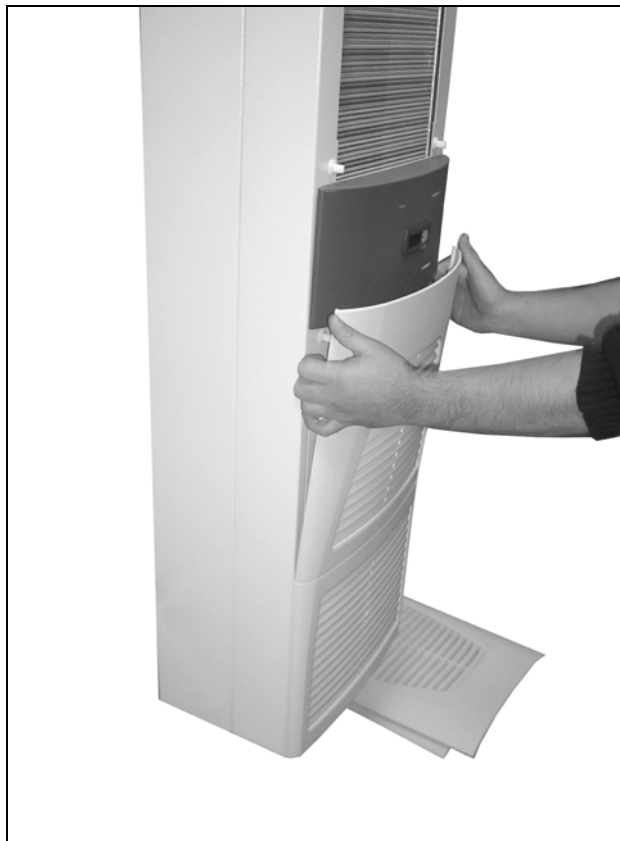
Abb. 57: Unteres Lamellengitter entfernen (1)
