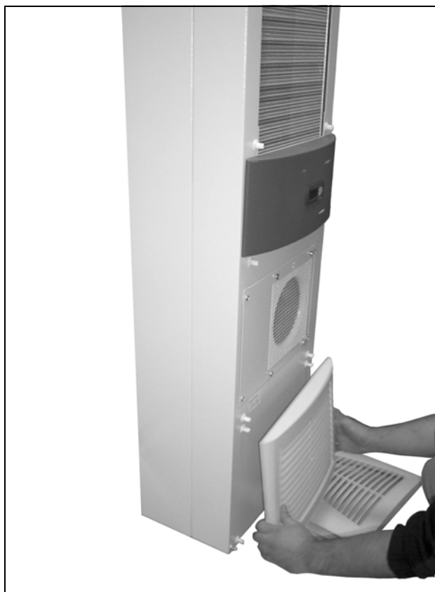
Abb. 58: Unteres Lamellengitter entfernen (2)
