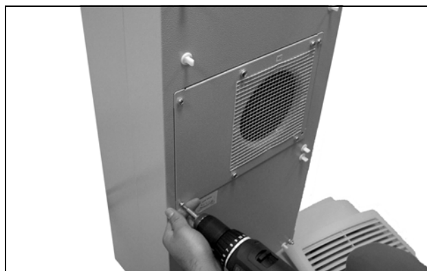
Abb. 63: Vier Schrauben des Außenkreislaufflüters lösen
