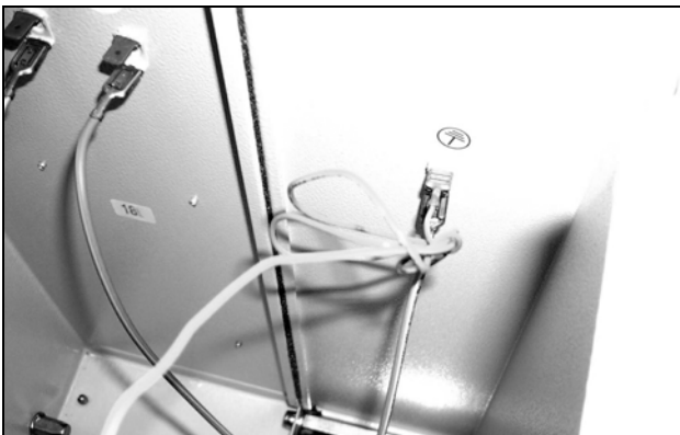
Abb. 68: Erdungskabel des Lüfters abziehen (1)
