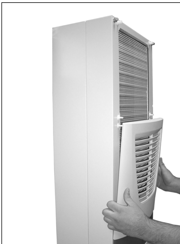
Abb. 56: Oberes Lamellengitter entfernen (3)
