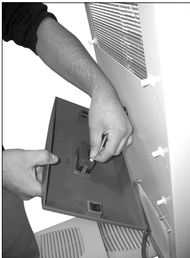
Abb. 38: Stecker vom Display abziehen (1)
