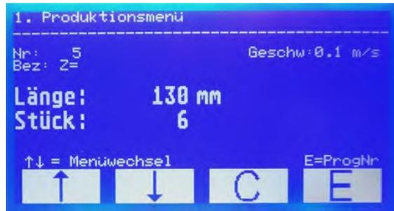
Abb. 3: Display, Anzeige nach dem Einschalten
