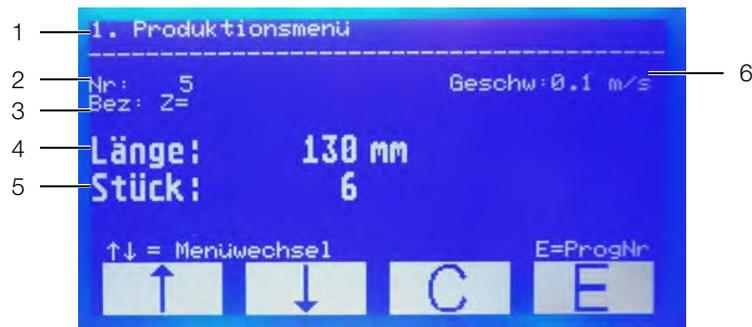
Abb. 4: Display mit Produktionsmenü
