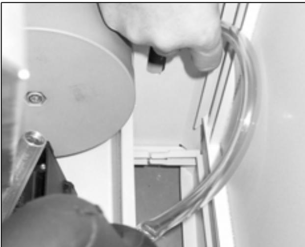
Abb. 9: Kondensatablauf aus dem Gerät herausführen
