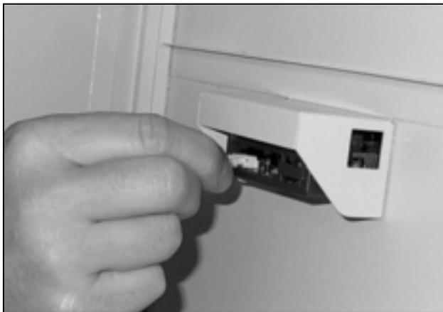
Abb. 15: Anschlusskabel Display anschließen
