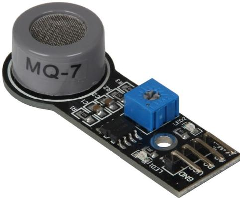
Dieser analoge Gassensor besitzt ein kleines Heizelement mit einem elektronisch-chemischen Sensor. Er ist für die Verwendung in Innenräumen geeignet. Er kann erst nach Beendigung der Aufwärmphase genaue Messwerte ausgeben. Das Heizelement muss mit zwei unterschiedlichen Spannungen (5 V / 1,4 V) betrieben werden.
