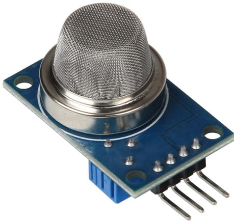
Dieser Analoge Gassensor besitzt ein kleines Heizelement mit einem elektronisch-chemischen Sensor. Er ist für die Verwendung in Gebäuden geeignet. Er kann erst nach Beendigung der Aufwärmphase genaue Messwerte ausgeben.
