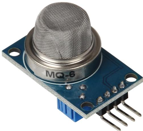
Dieser analoge Gassensor besitzt ein kleines Heizelement mit einem elektronisch-chemischen Sensor. Er ist für die Verwendung in Innenräumen geeignet. Er kann erst nach Beendigung der Aufwärmphase genaue Messwerte ausgeben.
