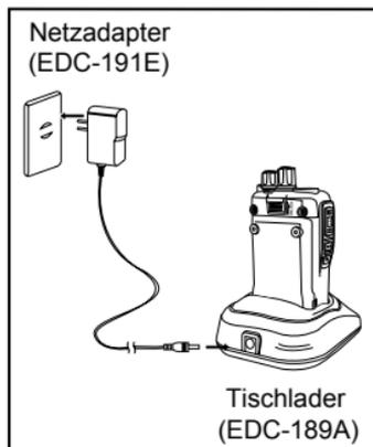
3. Funkgerät ausschalten, da der Akkupack bei eingeschaltetem Funkgerät nicht einwandfrei geladen wird.
