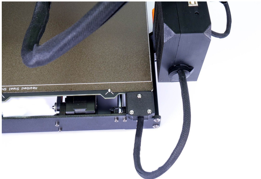
Bild 50 - Die Kabel sollten in einen Textilschlauch eingewickelt werden
