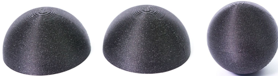
Bild 30 - Eine in zwei getrennten Teilen gedruckte Kugel, die miteinander verklebt sind.
