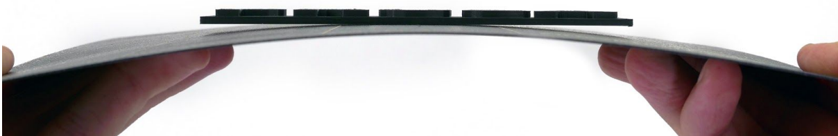
Bild 13 - Entfernen eines Modells von der PEI-Oberfläche durch Biegen der Federstahlplatte
