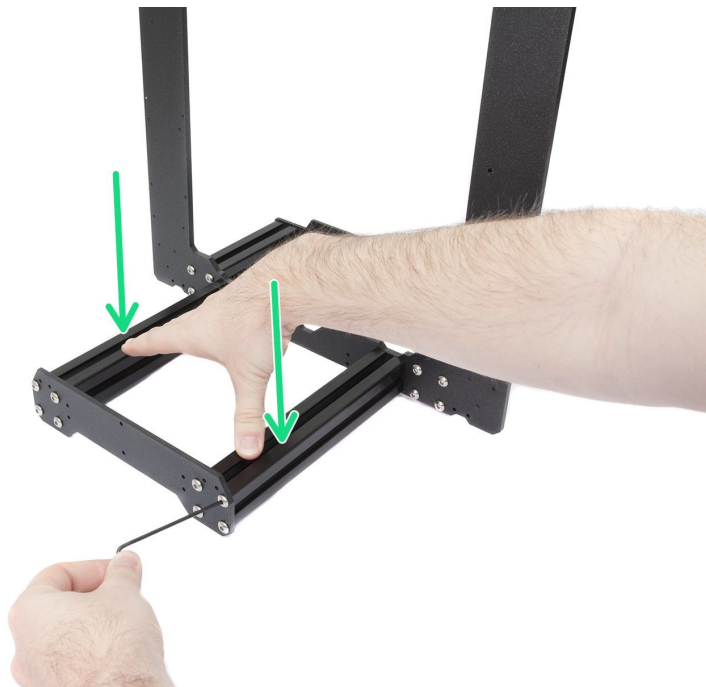
Bild 46 - Die richtige Verbindung von Rahmen, Platten und Aluminiumprofilen.
