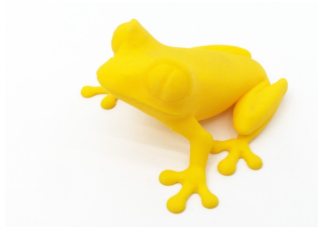
Bild 26 - der 50-Mikrometer-Baumfrosch wird häufig als 3D-Druck-Benchmark verwendet.
