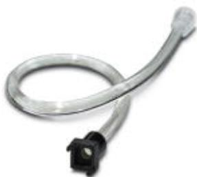
Flexibler Lichtleiter, transparent 3 mm aus PMMA (UL 94-V0) mit 6 mm Linse, aus Polycarbonat PC glasklar und LED-Gehäuse 6 x 6 mm Polycarbonat PC schwarz (UL 94), Länge: 150 mm unmontiert, für SMD TOPLEDs
