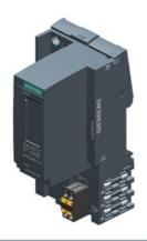
SIMATIC ET 200SP, PROFINET, 2-Port Interface-Modul IM 155-6PN/2 High Feature, 1 Steckplatz für BusAdapter, max. 64 Peripheriemodule und 16 ET 200AL Module, S2-Redundanz, Multi Hot Swap, 0,25ms, taktsynchroner Betrieb, optionale PN-Zugentlastung, inklusive Server-Modul
