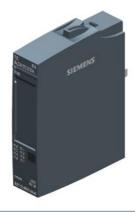
SIMATIC ET 200SP, Digitales Ausgangsmodul, DQ 8x 24V DC/0,5A Basic, Source Output (PNP,P-schaltend) Verpackungseinheit: 1 Stück, passend für BU-Typ A0, Farbcode CC02, Ersatzwertausgabe, Modul-Diagnose für: Versorgungsspannung
