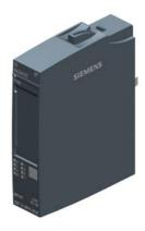
SIMATIC ET 200SP, Digitales Eingangsmodul, DI 8x 24V DC Basic, Eingangstyp 2 (IEC 61131), Sink Input, (PNP, P-lesend), Verpackungseinheit: 10 Stück, passend für BU-Typ A0, Farbcode CC01, Eingangsverzögerung 0,05..20ms; Modul-Diagnose für: Versorgungsspannung
