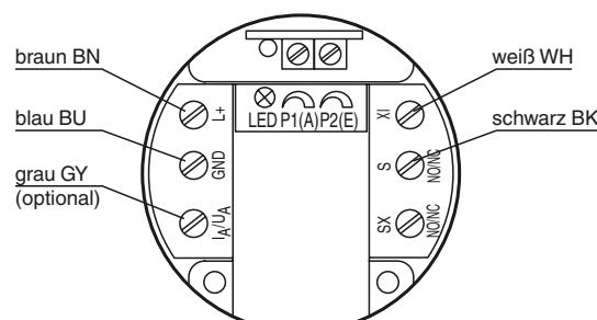
Die Anschlussklemmen  $I_A/U_A$  (Analogausgang) und SX (zweiter Schaltausgang) werden für die Programmierung nicht benötigt.
