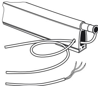
Sender und Empfänger in die Hohlkammer einschieben.
