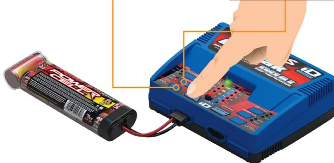
Drücken und halten Sie die Start-Taste(n) eine Sekunden lang. Das Ladegerät gibt einen Signalton ab, um zu signalisieren, dass der Ladevorgang begonnen hat. Drücken Sie einmal, um zu stoppen. Das Ladegerät gibt einen Signalton ab, um zu signalisieren, dass der Ladevorgang abgebrochen wurde. Die Ladestatus-LED leuchtet, so lange die Batterie aufgeladen wird.
