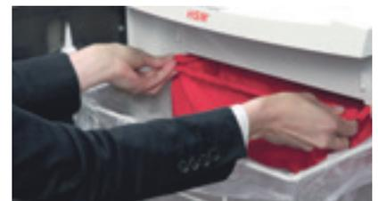
Separater Auffangbeutel für sortenreine Trennung des Schnittguts (nur bei CD-Vernichtung).
