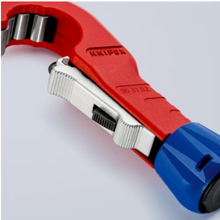
Durch die Einhandschnellfixierung kann das abgedeferte Schneidrad an den Durchmesser des Rohres herangeschoben und fixiert werden
