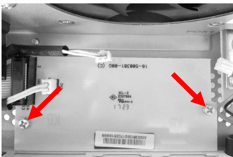
Abbildung 4: Schrauben auf beiger Platine entfernen
