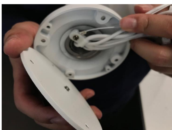
B. Adapter an der Kamera befestigen
