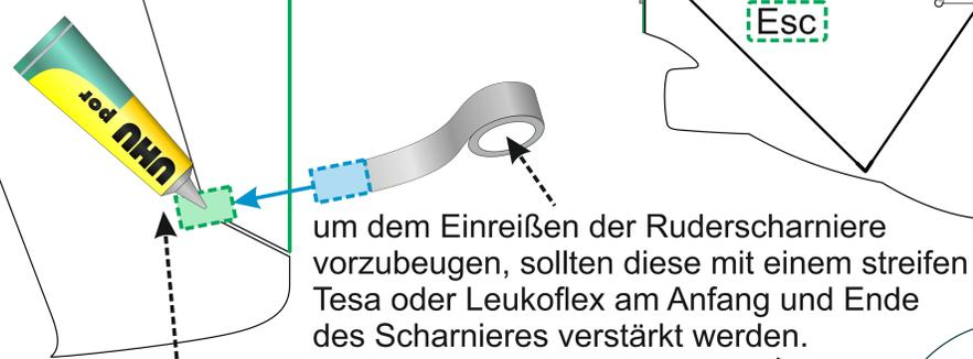
Um eine optimale Haftung zu gewährleisten, sollte unter das Scharnierband etwas UHU por gegeben werden.
