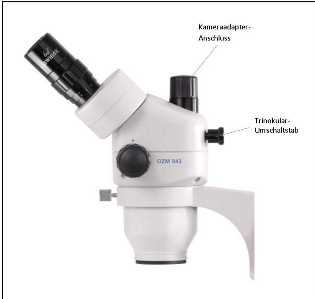
An die trinokularen Geräte der Serie OZM-5 können sowohl spezielle Mikroskopkameras als auch Spiegelreflexkameras angeschlossen werden, um Bilder oder Sequenzen eines Beobachtungsobjektes digital zu dokumentieren.
