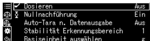
Mit den Navigationstasten ↑, ↓ <Stabilität Erkennungsbereich> wählen und mit **OK**-Taste bestätigen.
