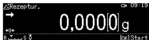
⇒ Erste Komponente einwiegen. Stabilitätsanzeige (→) abwarten, dann **OK**-Taste drücken. Der Wägewert wird automatisch ausgegeben. und in den Summenspeicher addiert. Anschließend erfolgt die automatische Trierung. Die Waage ist bereit für des Einwiegen der zweiten Komponente.
