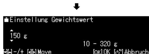
Mit den Navigationstasten Wert eingeben und mit **OK**-Taste bestätigen.
