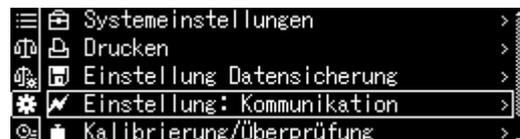
Mit den Navigationstasten Schnittstelle wählen und mit **OK**-Taste bestätigen.
