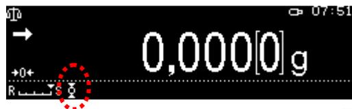
Bei aktivierter Zero tracking Funktion wird das Symbol
