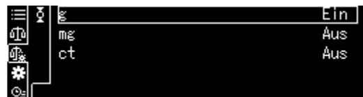
Mit den Navigationstasten **↑**, **↓** Einheit wählen und mit **OK**-Taste bestätigen.
