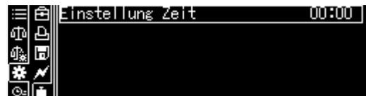
Mit den Navigationstasten Uhrzeit eingeben und mit **OK**-Taste bestätigen.
