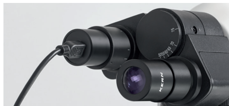
Okularkamera am Tubus befestigt
