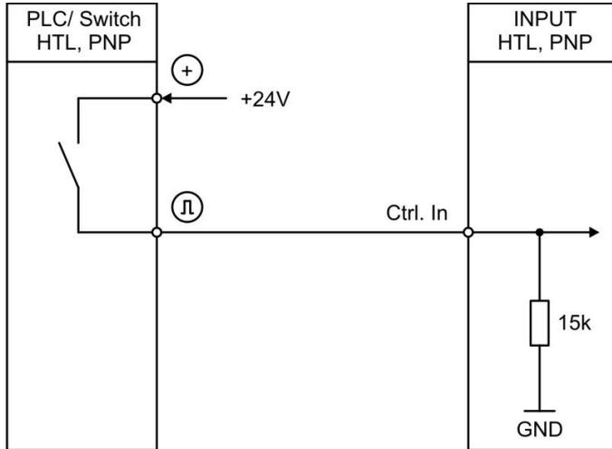
Grundsätzlich sind offene Control-Eingänge „LOW“. Die Eingangsstufen sind für elektronische Steuersignale ausgelegt.
