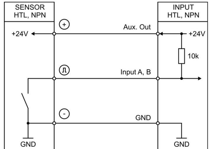
Grundsätzlich sind offene PNP Eingänge „LOW“ und offene NPN Eingänge „HIGH“. Die Eingangsstufen sind für elektronische Impulsgeber ausgelegt.
