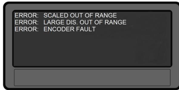
Befindet sich ein Messergebnis, welches auf dem Display angezeigt wird, außerhalb des darstellbaren Anzeigebereiches, so wird ein Fehlerbildschirm alle zwei Sekunden kurzzeitig eingeblendet. In diesem erscheint, welcher Anzeigewert über- bzw. unterschritten wurde.
