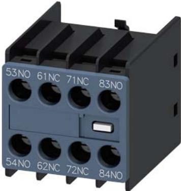
Hilfsschalter frontseitig, 2 S + 2 Ö Strombahn 1 S, 1 Ö, 1 Ö, 1 S für Hilfsschütze Baugröße S00 Schraubanschluss 53/54, 61/62, 71/72, 81/82 physisch kodiert; nur mit HiSchützen 3RH2140\* u 3RH2440\* kombinierbar (nach EN 50011)
