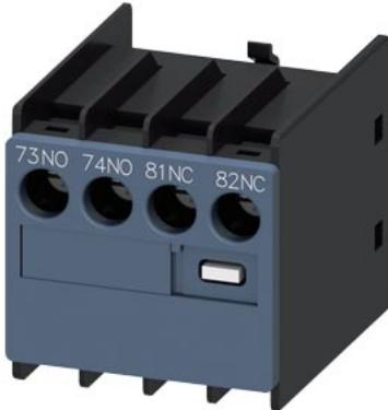
Hilfsschalter frontseitig, 1 S + 1 Ö Strombahn 1 S, 1 Ö Anschluss von oben für 3RH2 und 3RT2 Schraubanschluss 73/74, 81/82
