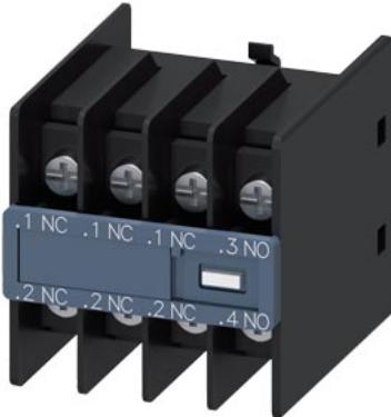
Hilfsschalter frontseitig, 1 S + 3 Ö Strombahn 1 Ö, 1 Ö, 1 Ö, 1 S für 3RH2 und 3RT2 Ringkabelschuhanschluss .1/.2, .1/.2, .1/.2, .3/.4
