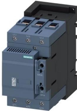
Kondensatorschütz, AC-6b 100 kVA<sub>r</sub>, / 400 V 2 Ö, AC 50-60 Hz / DC 20-33 V 3-polig, Baugröße S3 Schraubanschluss
