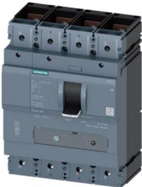
Leistungsschalter 3VA1 IEC Frame 400 Schaltvermögenklasse S Icu=55kA @ 415V 4-polig, Anlagenschutz TM240, ATAM, In=400A Überlastschutz Ir=280A...400A Kurzschlusschutz li=5...10 x In N-Leiterschutz 50% Schraubenflachanschluss
