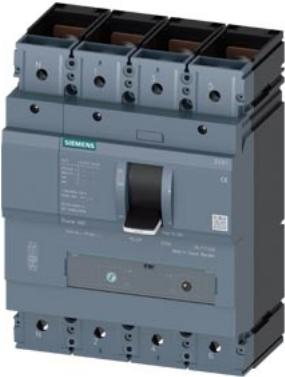
Leistungsschalter 3VA1 IEC Frame 630 Schaltvermögenklass S Icu=55kA @ 415V 4-polig, Anlagenschutz TM240, ATAM, In=630A Überlastschutz Ir=440A...630A Kurzschlusschutz li=4...8 x In N-Leiterschutz 50% Schraubenflachanschluss
