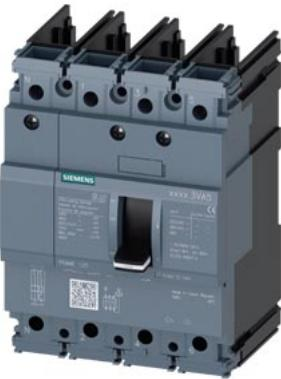
Leistungsschalter 3VA5 UL Frame 125 Schaltvermögenklasse S 25kA @ 480V 4-polig, Anlagenschutz TM210, FTFM, In=110A Überlastschutz Ir=110A fest eingestellt Kurzschlusschutz li=10 x In N-Leiterschutz 100% ohne Anschluss
