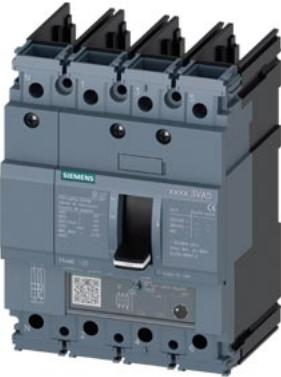
Leistungsschalter 3VA5 UL Frame 125 Schaltvermögenklasse M 35kA @ 480V 4-polig, Anlagenschutz TM230, FTAM, In=125A Überlastschutz Ir=125A fest eingestellt Kurzschlusschutz li=5...10 x In N-Leiterschutz 100% ohne Anschluss
