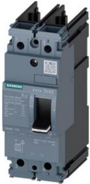
Leistungsschalter 3VA5 UL Frame 125 Schaltvermögenklasse H 65kA @ 480V 2-polig, Anlagenschutz TM210, FTFM, In=70A Überlastschutz Ir=70A fest eingestellt Kurzschlusschutz Ii=10 x In ohne Anschluss
