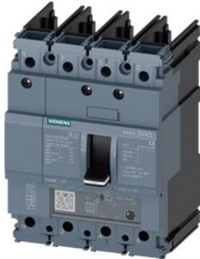
Leistungsschalter 3VA5 UL Frame 125 Schaltvermögenklasse H 65kA @ 480V 4-polig, Anlagenschutz TM240, ATAM, In=80A Überlastschutz Ir=63A...80A Kurzschlusschutz Ii=5...10 x In N-Leiter ungeschützt ohne Anschluss
