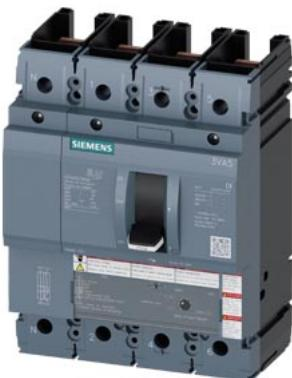
Leistungsschalter 3VA5 UL Frame 250 Schaltvermögenklasse C 100kA @ 480V 4-polig, Anlagenschutz TM230, FTAM, In=225A Überlastschutz Ir=225A fest eingestellt Kurzschlusschutz li=5...10 x In N-Leiterschutz 100% ohne Anschluss
