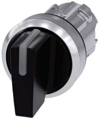
Knebelschalter beleuchtbar, 22 mm, rund, Metall hochglanz, schwarz, Knebel kurz, 3 Schaltstellungen I-O<II, links verrastend, rechts tastend, Schaltwinkel 2x45°, 10:30h/12h/13:30h
