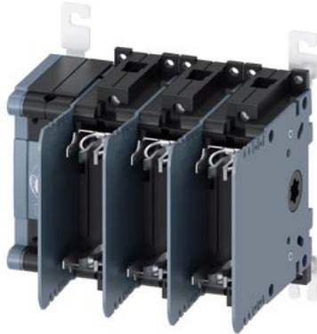
Lasttrennschalter mit Sicherung 3KF SITOR, 80A, Baugr. 1, 3-polig, für NH-Sicherung Gr. 000 für Halbleiterschutz Frontantrieb links, Grundgerät ohne Handgriff, Rahmenklemme ohne Sicherungen
