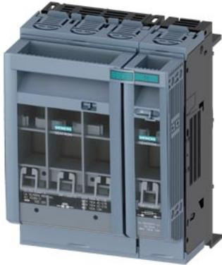
SENTRON, Sicherungslasttrennschalter 3NP1, 4-polig, NH00, 160 A, für Sammelschienensystem 8US 60mm, Flachanschluss, Abdeckebene 32/70mm
