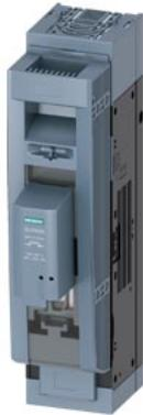
SENTRON, Sicherungslasttrennschalter 3NP1, 1-polig, NH1, 250 A, für Aufbau und Einbau auf Montageplatte, Rahmenklemme, Sicherungsüberwachung, elektronisch EFM15, Abdeckebene 70mm
