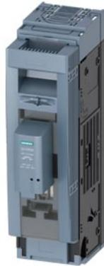
SENTRON, Sicherungslasttrennschalter 3NP1, 1-polig, NH2, 400 A, für Aufbau und Einbau auf Montageplatte, Rahmenklemme, Sicherungsüberwachung, elektronisch EFM15, Abdeckebene 70mm
