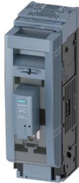
SETRON, Sicherungslasttrennschalter 3NP1, 1-polig, NH3, 630 A, für Aufbau und Einbau auf Montageplatte, Flachanschluss, Sicherungsüberwachung, elektronisch EFM15, Abdeckebene 70mm
