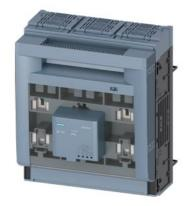
SENTRON, Sicherungslasttrennschalter 3NP1, 3-polig, NH3, 630 A, für Sammelschienensystem 8US 60mm, Rahmenklemme, Sicherungsüberwachung, elektronisch EFM15, Abdeckebene 32/70mm
