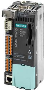
SIMOTION Drive-based Control Unit D410-2 DP; programmierbare Einachs- Motion-Control-Steuerung mit Mehrachs-Option; Schnittstellen: 5 DI, 8 DI/DO 3 F-DI, 1 F-DO, 1 AI 1 Encoder, 1 Drive-CLiQ 2 PROFIBUS, 1 Ethernet
